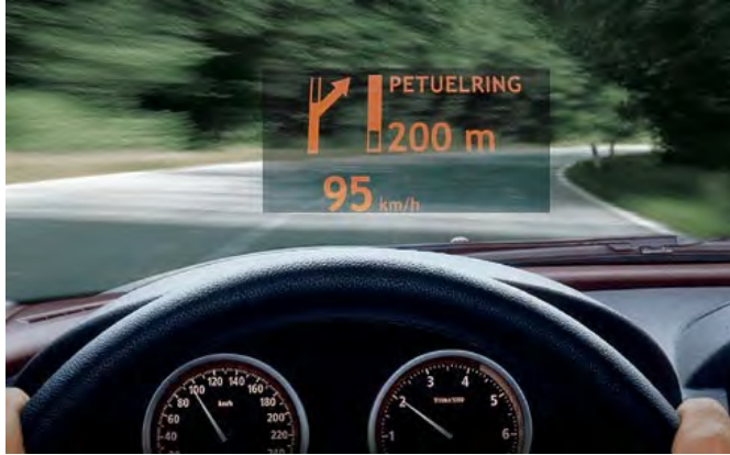
Abbildung 2.2: Ein Head-Up-Display, wie es in einem Auto eingesetzt werden kann. Grafik aus [BMW14].
