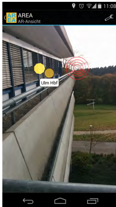
Abbildung 6.4: Rechter Punkt ist der ursprünglich verwendete POI. Der linke Punkt ist ein von OpenGL ES 2.0 gezeichneter Punkt. Die rote Markierung stellt den Punkt des OnClickListener dar.
