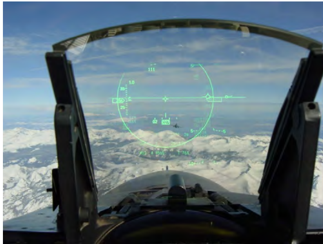
Abbildung 2.1: Ein Head-Up-Display, wie es in Düsenflugzeuge eingesetzt wird. Grafik aus [Fau14].
