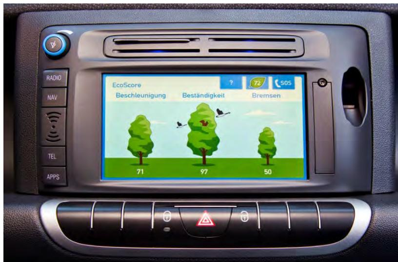
Abbildung 2.6: EcoScore - Im Gegensatz zum EcoSpeedometer reagiert das EcoDisplay nicht sofort auf das Fahrverhalten, sondern zeigt die Kraftstoffeffizienz für einen bestimmten Zeitraum an – in diesem Fall für die Dauer der letzten Fahrt. Es zielt daher auf eine langfristige Verhaltensänderung ab, indem Informationen über einen längeren Fahrzyklus bereitgestellt werden [15].
