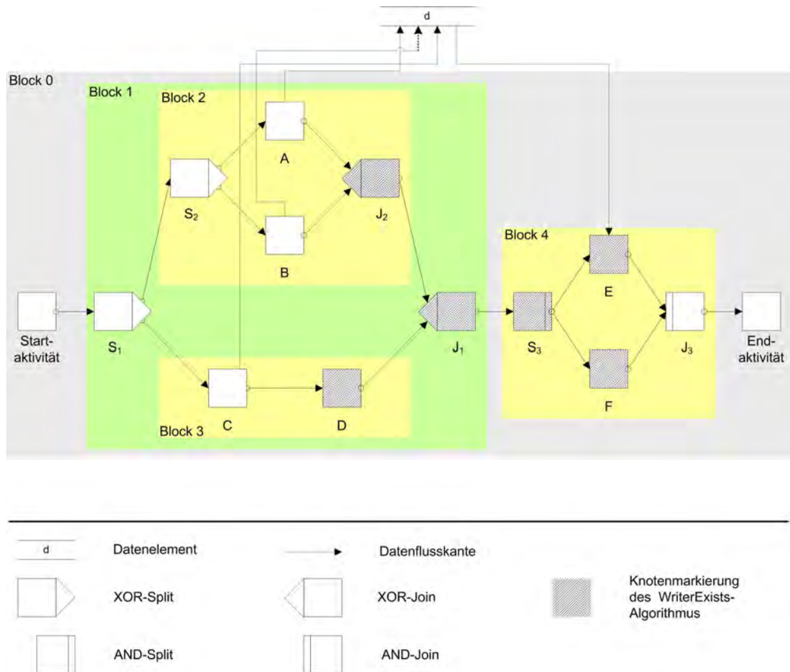
Abbildung 2.1: Blockstrukturierung und Datenflussmodellierung in einem ADEPT-Prozess
