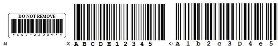
Abbildung 4.9.: a) Code 39 Format [44], b) Code 93 Format [45], c) Code 128 Format [46]
