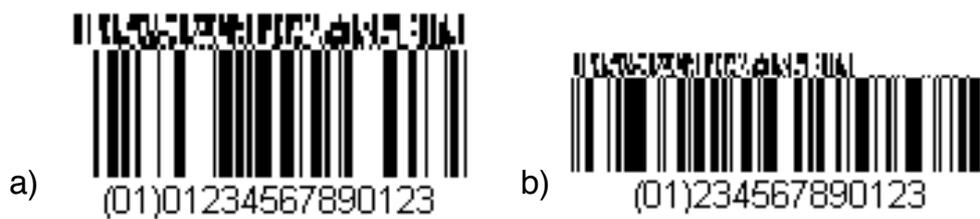
Abbildung 4.12.: a) RSS-14 Format b) RSS Expanded Format [48]
