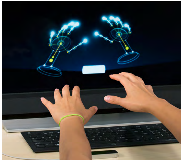
Abbildung 2.10: Bewegungssteuerung über den Leap Motion Controller [leaf]
