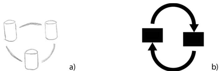
Abbildung 54: Skizze und Symbol zur Darstellung von Synchronisationspunkten
