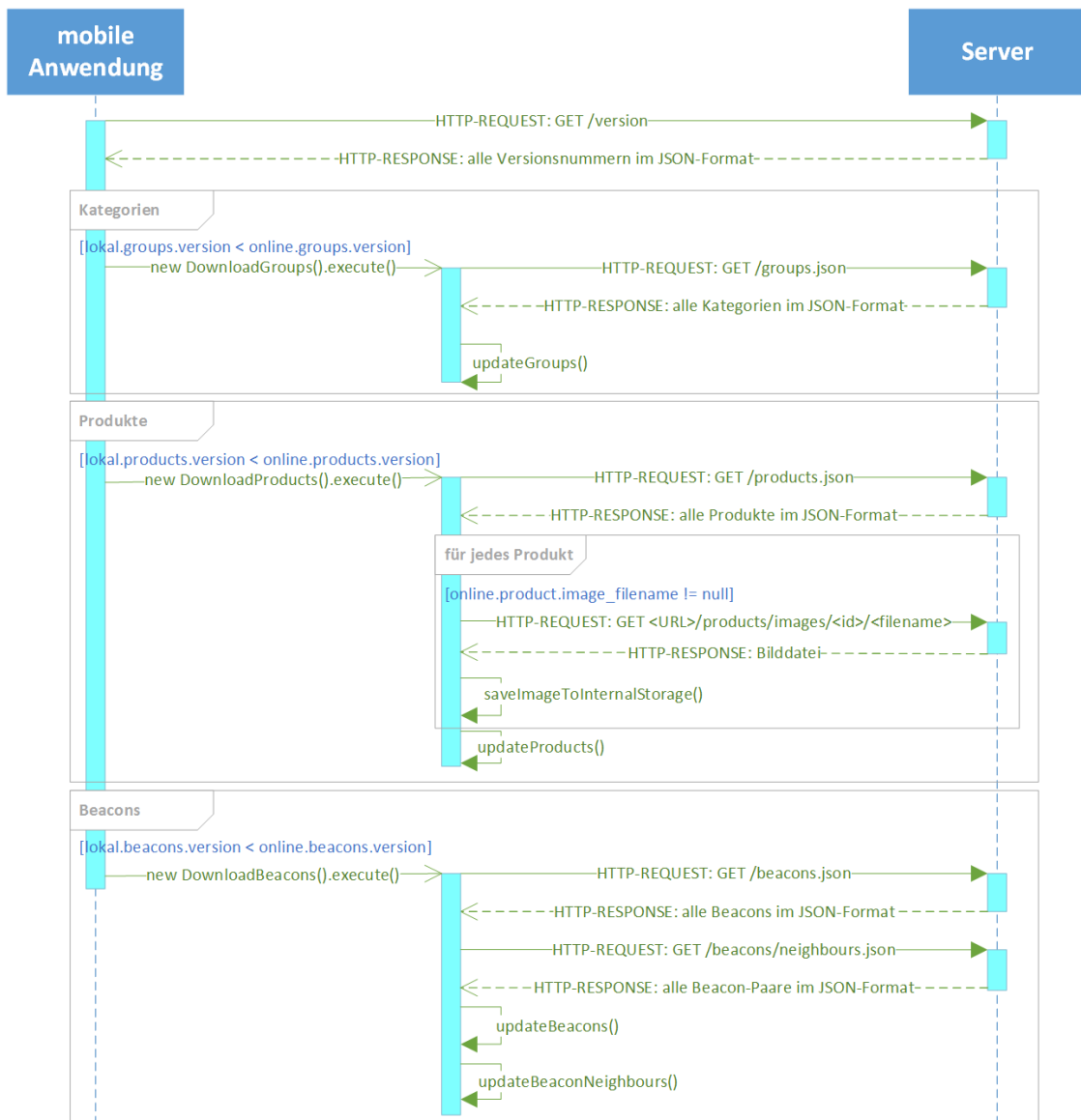
Abbildung 6.16: Sequenzdiagramm der vollständigen Synchronisation.
