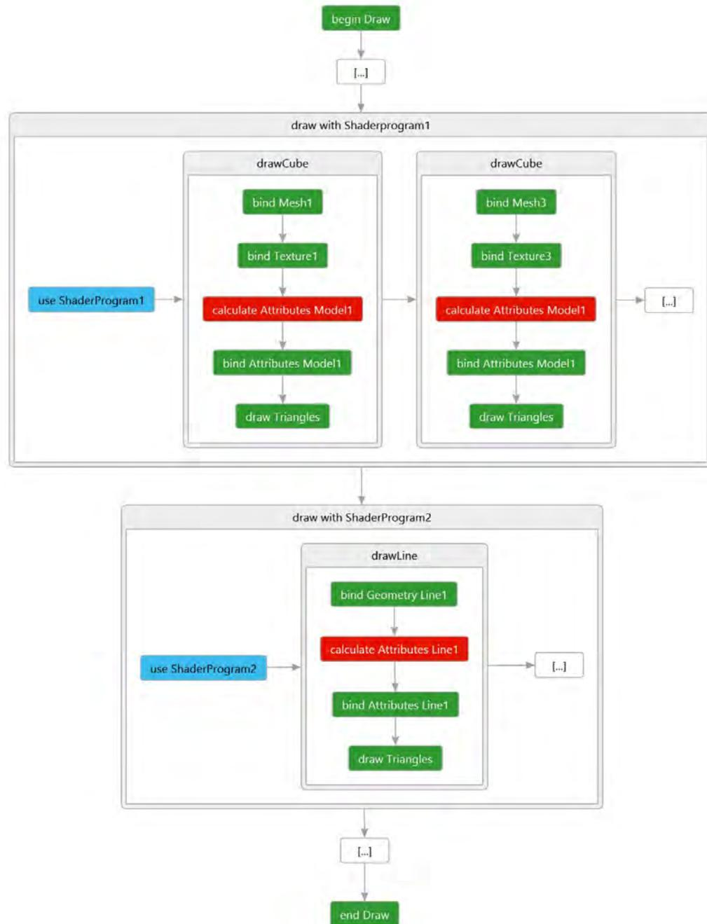
Abbildung 5.5.: Erste Verbesserung des Renderers; Blaue Funktionsaufrufe sind reduziert worden und werden somit nur ein mal pro Shaderprogramm benötigt.
