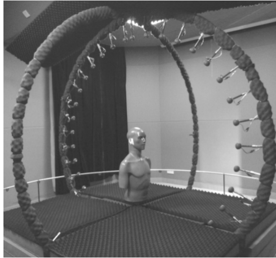
Abbildung 2.4: Versuchsaufbau zur Messung von HRTFs [32]
