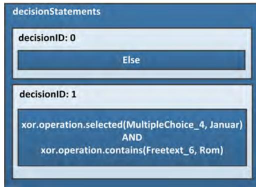
Abbildung 4.3: Aufbau und Beispiel von Entscheidungsfunktionen.
