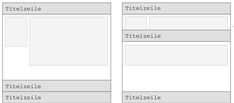
Abbildung 30: Schema der Öffnung eines geschlossenen Bereichs in einem AccordionControl . Der zweite Bereich öffnet sich und schließt dabei den ersten geöffneten Bereich darüber.
