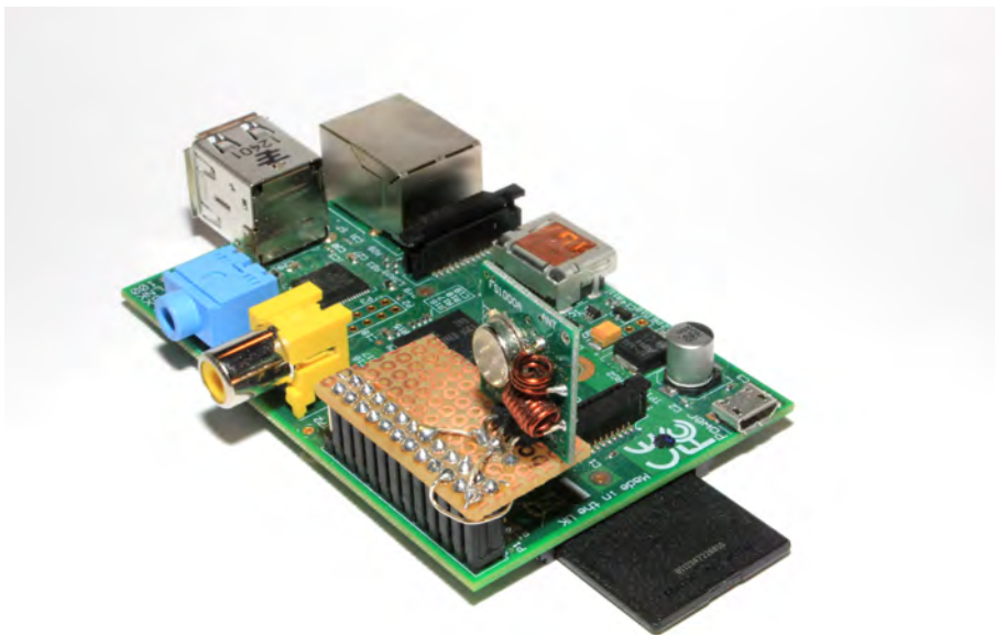
Abbildung 4.8: Raspberry Pi mit angeschlossenem Transmitter
