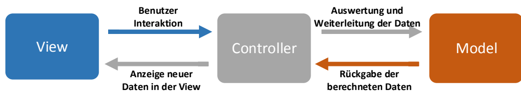
Abbildung 4.1.: Das Model View Controller Konzept nach [Bus96]
